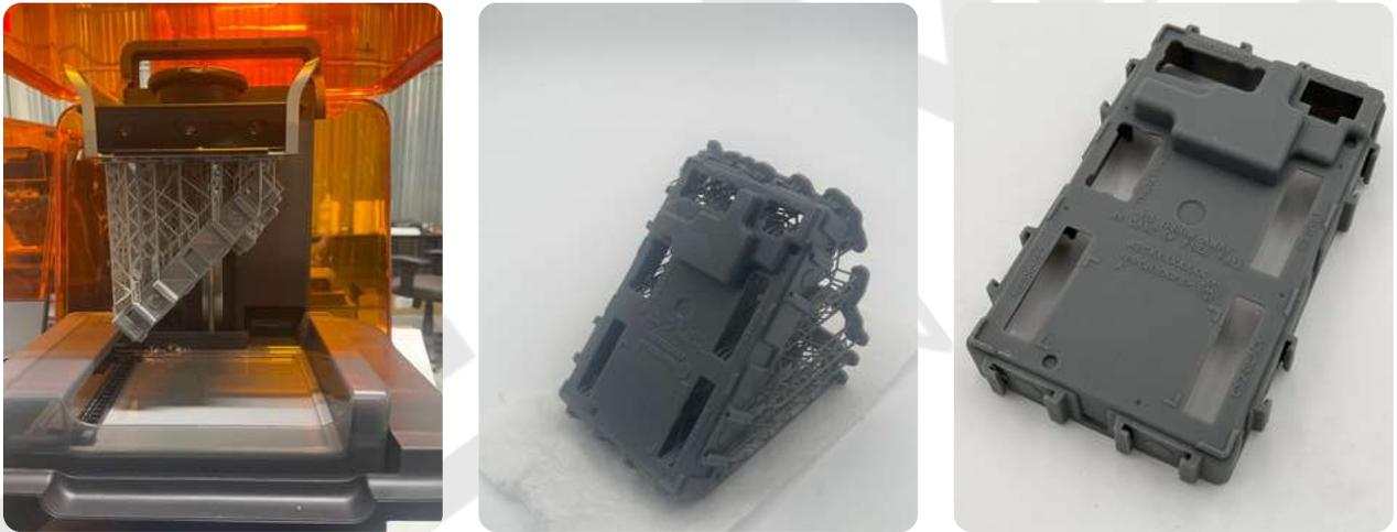
在Form 3+（N3）上完成的零件，分別展示了不同階段的狀態：列印完成後還在列印機上的狀態（左），經過第一次清洗但支撐結構仍在的狀態（中），以及移除支撐結構並固化後的最終完成品（右）。
