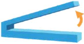
建議最小開口角度： $10^{\circ}$  (35mm 長  $\times$  10mm 寬  $\times$  3mm 厚)
