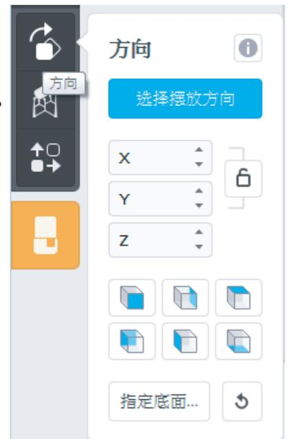
將滑鼠停在X、Y或Z軸旋轉數據時，上下滾動滑鼠滾輪，可單獨變換該軸角度。
