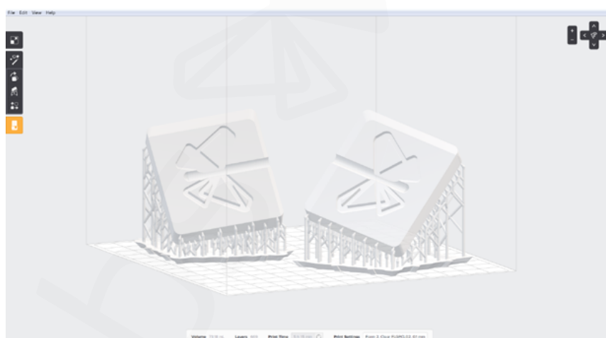
列印模具在preform軟體中擺放的樣子，模具內腔朝上
