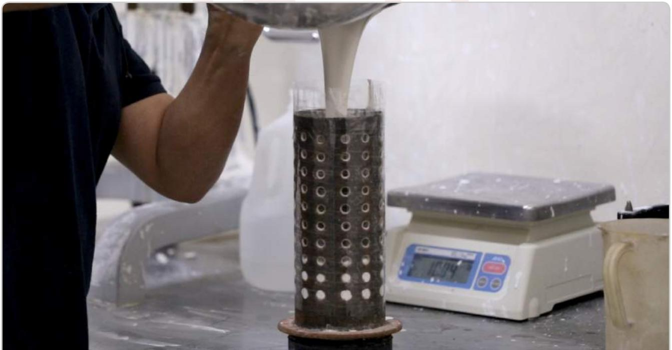
慢慢倒入混合物質至鑄造瓶內。請鎖定一側緩緩倒入，避免衝擊力太強導致腦膜毀損。
