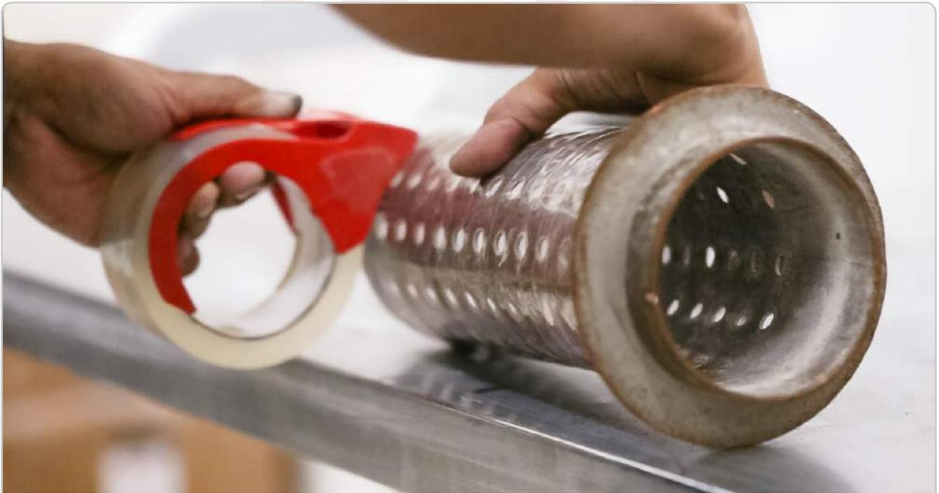
在澆注底座裝上一個鑄造燒瓶，如瓶上有穿孔，用透明膠帶纏繞燒瓶將穿孔堵住。
