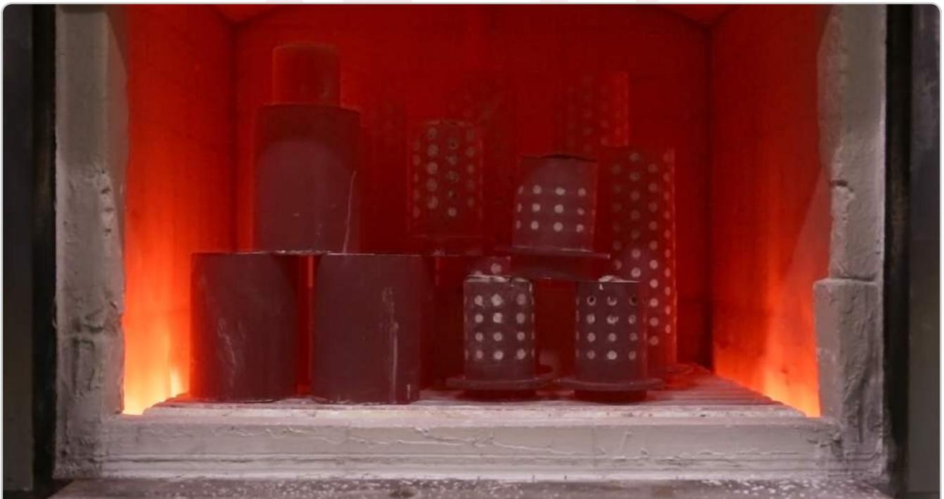
將鑄造燒瓶放入爐中，根據本說明第2頁提供的燃燒時程進行加熱，將模具從鑄造金屬和加熱爐中移除。
